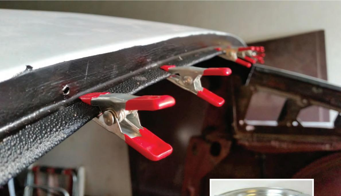
**Mit der Zeit schrumpfen viele Kunststoffteile. Besonders nervig ist es an der Stelle, wo Dashboards zerreißen oder der Dachhimmel sich immer mehr spannt und schließlich an den Seiten abgeht und Wellen wirft. Zeit, einen neuen einzuziehen.**
