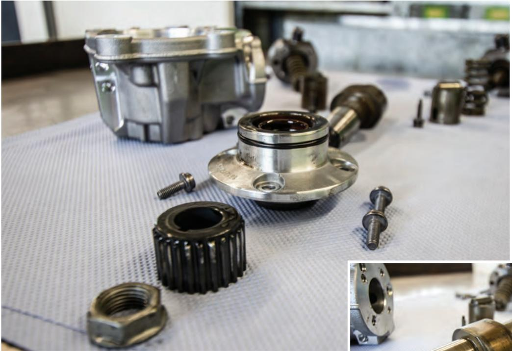
*CP4 Hochdruckpumpe nach AdBlue: Die Lauffläche ist bereits deutlich beschädigt*
