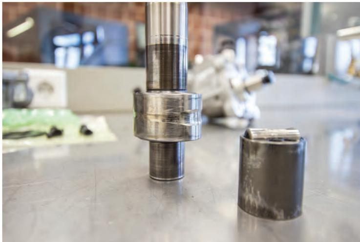
Hier eine CP4 Hochdruckpumpe, deren Kolben sich verdreht. Mit jeder Umdrehung der Nocke, die ihn Druck auf den Kraftstoff hin zu den Injektoren aufbauen lässt, schleift er sich dann weiter rein. Spähne und Abrieb erledigen dann die Injektoren - es wird teuer. Nicht zu hören: Der schleichende Tod!
