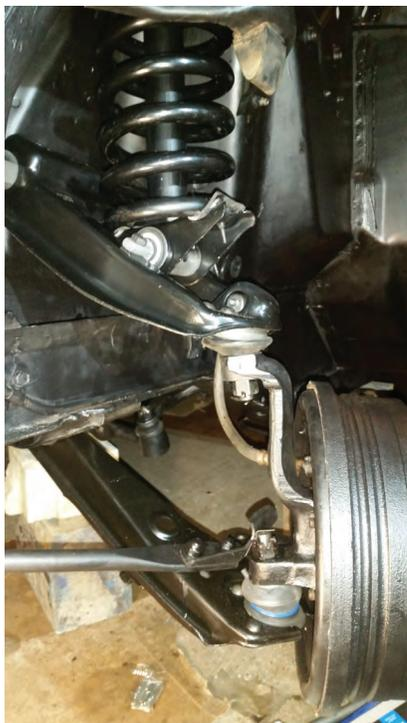
Ein frisches Fahrwerk entzückt! Einfach aufgebaut bis auf den Sturz. Der hier sichtbare Schenkel wird mit Schimms links an der Wand distanziert, was den Einstellprozess aufwendig gestaltet
