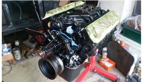
Zollgewinden hat man diese nicht immer vorrätig. Der Ständer ist absolut stabil, und man kann dank axialer Aufhängung (beim Einbau fetten!) den ganzen Motor drehen. Wir empfehlen bei der Ständerwahl das Gewicht des Motors mal zwei zu nehmen, da man sonst kein gutes Gefühl hat, wenn sich der Motor beim Abmachen vom Kran nach unten neigt.
