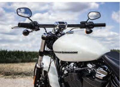
der 13,2 Liter Tank voll ist. Der Schwerpunkt des ganzen Gespanns ist weit weit unten. Der Fahrkomfort der Federung ist übrigens sehr ausgewogen gelungen. Der Dämpfer hinten ist einstellbar. Die Bremsen sind wohl dosiert, vorne sorgen vier Kolben (hinten zwei) für angemessene Verzögerung. ABS ist bei Harley übrigens Serie.
