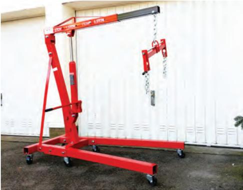
brauchen, bis man den Kippwinkel über die Kettenlängen zum Balancer optimal hinbekommt (anders als am Bild muss die Kurbel vom Kran weg-schauen, da sie sonst am höchsten Punkt verkeilt = wieder runter).
