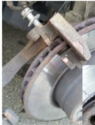
Bremsträger abschrauben - diese Schrauben sind sehr fest!
