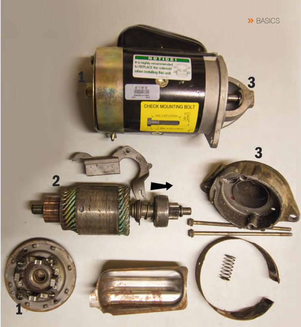
**1** Hinterer Deckel mit den Schleifkontakten und Ankerlager
