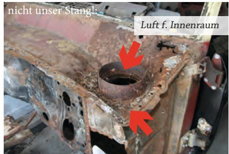
Deckblech abgebohrt: Hier würde es ablaufen, aber alles ist schon durchgerostet: ersetzen
