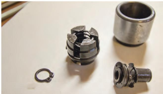
*Nachstellmechanismus in vielen ATE Sätteln wie z.B. Porsche 914, diverse Alfas. Die vorderen Teile bewegen den Kolben auf der Spindel, die man am oberen Bild sieht.*
