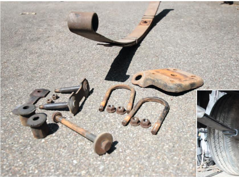
Komplette Blattfeder samt Aufnahmen und Haltern. Oben an der Feder sieht man gut das Auge, dessen Position die Fahrzeughöhe mitbestimmt
