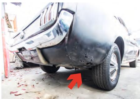
*Heckspitzen: unten durch weil dann immer feucht Austrennen und vorgefertigte kaufen - typisch eben*
