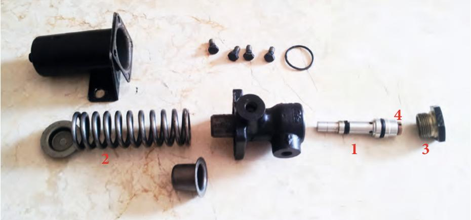
*Bremskraftregler: Gegen diese massive Feder drückt Ihr Fuß. Solange die Feder nicht komprimiert wird, kommt die Kraft hinten an den Belägen an. Bei mehr wird sie gestaucht und die Leitung verschlossen.*
