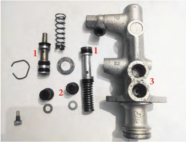
Hauptbremszylinder von ATE. Schön zu sehen: die Tandemkolben für die zwei Kreise (1). Unten liegen die Gummidichtungen (2) für die getrennten Zuläufe (3) aus dem (Bremsflüssigkeits-)Reservoir.
