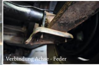
Verbindung Achse - Feder
