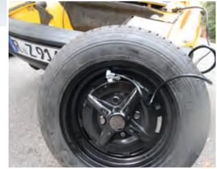
"pfff/sproiz", zudrehen, Pedal loslassen usw. So lange, bis keine Blasen mehr aus dem Schlauch kommen. War der Hauptbremszylinder leer, wird das locker 30 mal gemacht werden müssen - je nach Länge der Leitungen. Dann kommt das nächste Rad. Bis alle durch sind.
