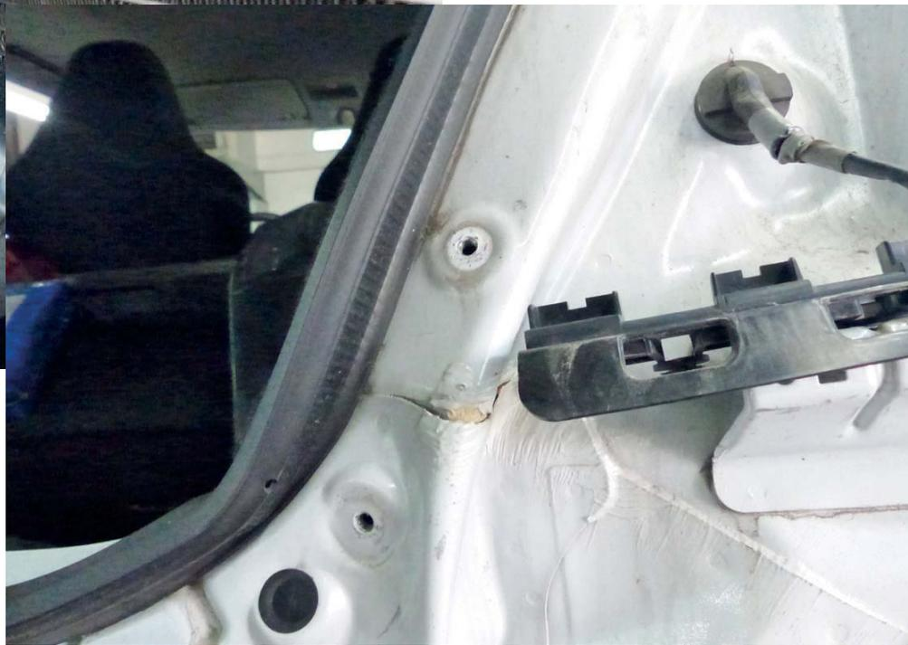
Äussere Schäden sind schnell erkannt, darunter verbergen sich meist dann weitere Verformungen, die erst durch Zerlegung festgestellt werden können. Oben rechts der Schlossträger beim Kühler, rechts das Abschlussblech hinten: Am Ende ein wirtschaftlicher Totalschaden.
