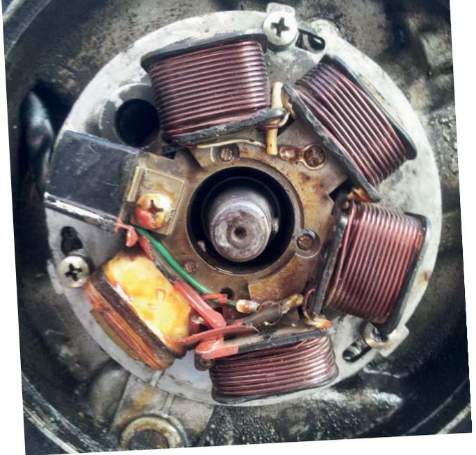
Elektronische Zündung einer Vespa, die 3 Kreuzschlitzschrauben fixieren die Ankerplatte - gelöst und nach links gedreht wird früher gezündet!
