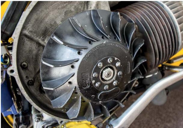
Luftkühlung einer 2Takt-Vespa. Das Lüfterrad steckt auf der Kurbelwelle. Darunter sind je nach Modell ab den 80ern elektronische Zündungen verbaut, vorher unterbrechergesteuerte. Hier fehlen Markierungen. Am besten werden die am Lüfterrad/Motor angebracht und dann abgeblitzt. Nervig: zum justieren muss dann das Lüfterrad immer wieder runter.
