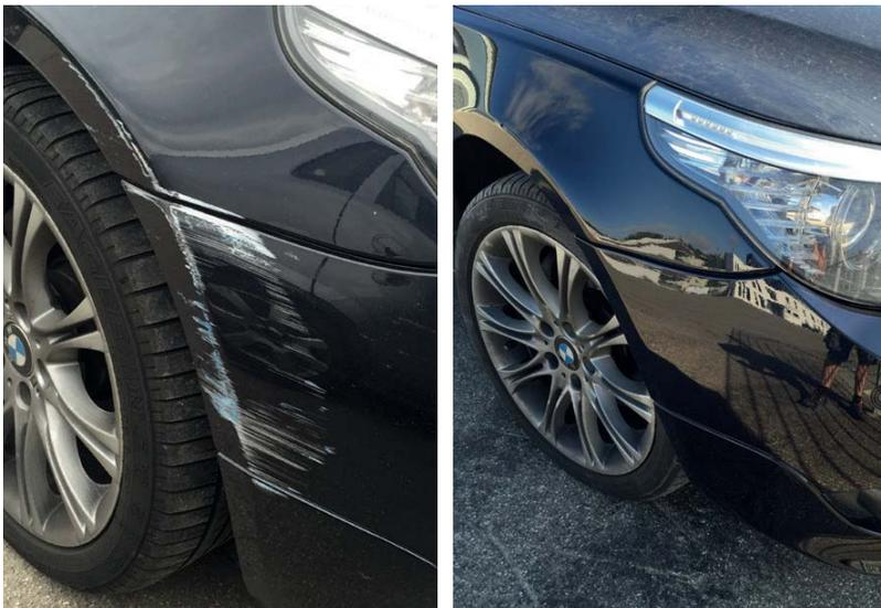
Unser Beispiel: Ein Mauerkontakt mit Folgen - der Lack ist ab und das Material darunter tief verkratzt.
