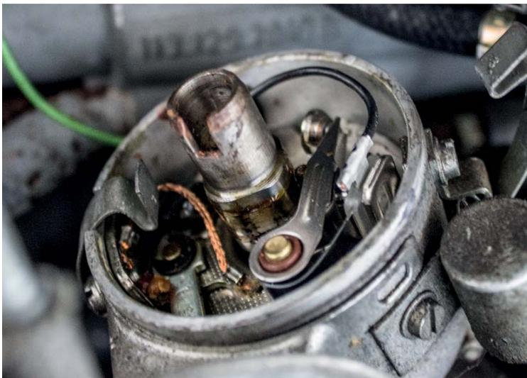
Unterbrecher eines VW Käfer Cabrios, hier wird der ganze Verteiler zur Zünderstellung gedreht.
