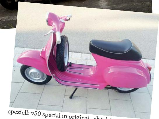
80er gab es nahezu KEINE Veränderungen. Motortechnik und Bauprinzip sind sowohl bei den Largeframes (mit abnehmbaren Kotflügeln, etwas größer, 80-200ccm) und den Smallframes (Vergaser im Rahmen, 50ccm-125ccm) gleich geblieben. Bis eben die Plastikbomber kamen. Und dann die 4-Takter.
