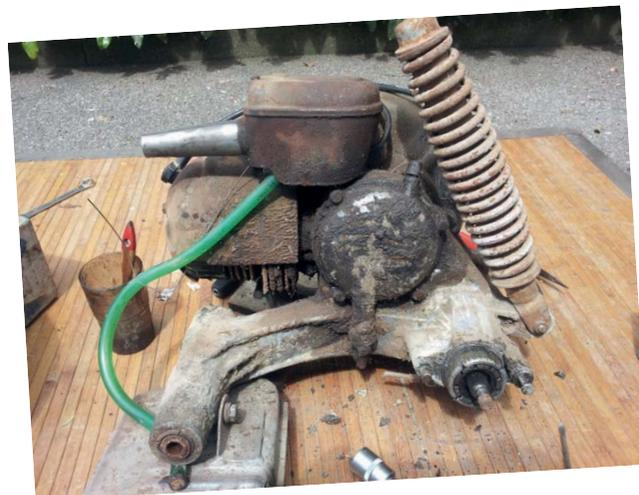
125ccm auf denen der Vergaser noch DIREKT am Zylinder sitzt. Dickster Dreck und Ölschlamm: Alles muss auseinander, die Kurbelwelle wird ersetzt, die brüchige Elektrik überholt
