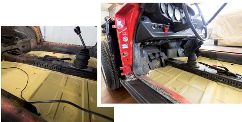
Off Restaurierung notwendig (alles außer Chassis/Fahrgastzelle kommt weg -> Tauchbad -> ausrichten -> lacken) oder es werden nur die notwendigen Teile behandelt.
