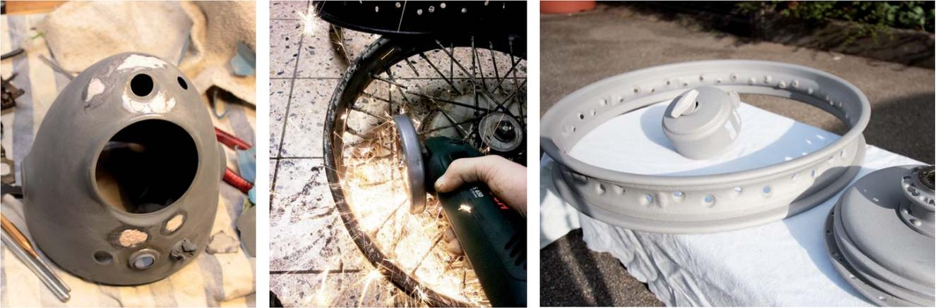
Erste Arbeiten: Scheinwerfertopf schleifen und ausbessern, Speichen durchschneiden und samt Luftfilter zum Strahlen bringen. Rechts: so sehen unbehandelte Stahlteile dann aus. Unten: frisch gelackt und noch unpoliert. Kleine Teile kann man gänzlich selbst instand setzen.
