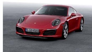
testen. Erneut ereilt die Gemeinde eine tiefgreifende Umstellung: der Turbo hält in alle 11er Motoren Einzug. 370 PS Standard, satte 420 PS im S-Model – die PS Zahl des 996 Turbos. Unterschied: aus 3 Litern Hubraum mit massiven 500 NM Drehmoment – in 3,9 Sekunden auf 100 km/h. Wir sind gespannt!
