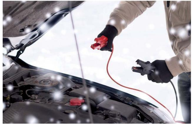
einer Stunde. Natürlich sollten Sie noch herausfinden, warum die Batterie leer war oder wie sie nach der Tiefentladung noch funktioniert. Leer werden kann sie durch das Fahren von Kurzstrecke, da wird dann inklusive Startvorgang mehr entnommen als durch Fahrt reingeladen (Sitzheizung, Scheibenheizung, Lüftung, Radio und u.a. Licht saugen zusätzlich Strom). Oder war ein Verbraucher an über Nacht? Oder ist die Batterie einfach am Lebensende?
