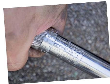
Nun ziehen wir die Schrauben (Reihenfolge: über Kreuz anziehen!) handfest an. Dann lassen wir das Fahrzeug langsam(!) ganz nach unten. Nun ziehen wir nach und nach (2-3 Stufen) bis zum richtigen Drehmoment (Betriebsanleitung, meist zw. 120 und 140 NM) fest. Wer keinen Drehmomentschlüssel (ca. 30 Euro reichen) hat: Mit Druck von ca. 30 kg bei 40 cm Hebel (Ratsche) ist man gut bedient. Das darf also schon fest! Reifendruck kontrollieren, ggf. befüllen oder ablassen und gute Fahrt!
